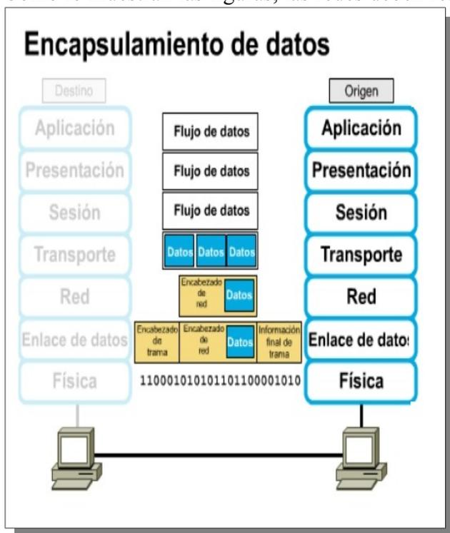
**2. Empaquetar los datos para ser transportados de extremo a extremo.** Los datos se empaquetan para ser transportados por la internetwork. Al utilizar segmentos, la función de transporte asegura que los hosts del mensaje en ambos extremos del sistema de correo electrónico se puedan comunicar de forma confiable.
